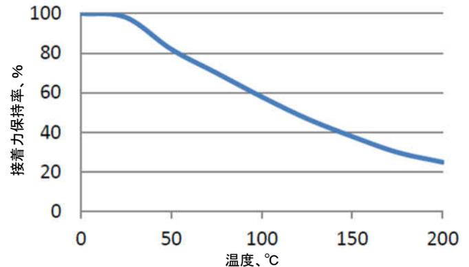
高温剪断試験は、軟鋼を用いて実施したもの。室温で24時間硬化させ、所定の温度で30分放置してから試験を実施。
