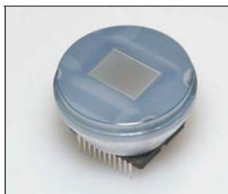
蛍光面をコーティングしたテーパファイバをマウントした CCD とそれを用いたカメラシステム
