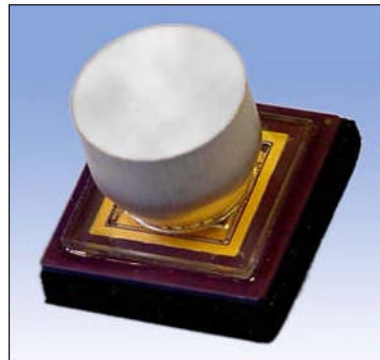
蛍光面をコーティングしたテーパ光ファイバ結合 CCD
