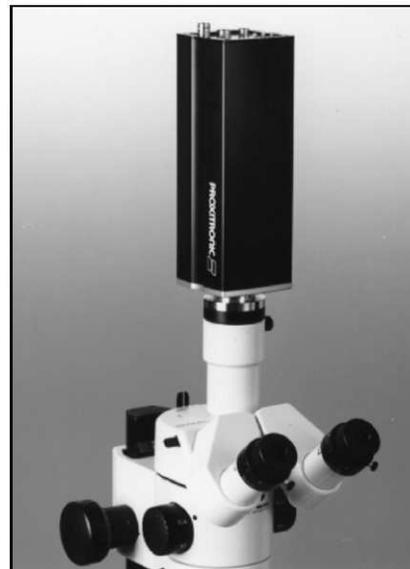
Figure 3: C-マウントによる顕微鏡
