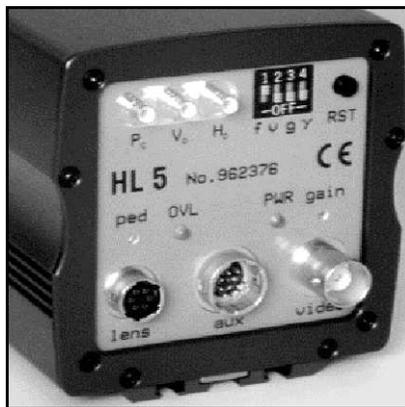
Figure 2: HL5 高感度カメラのリアパネル
