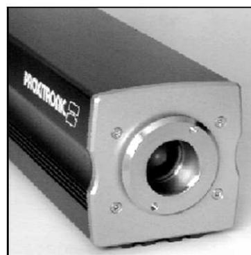
Figure 1: C-マウントアダプタを備えた軽量カメラのフロントビュー。
